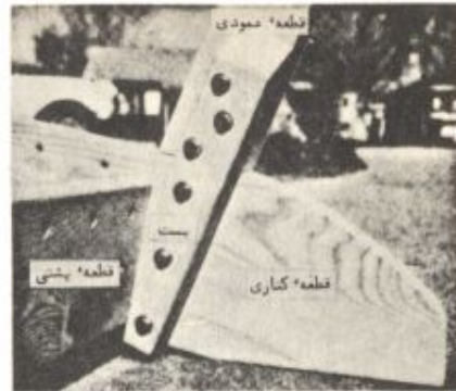
شکل ۲ - نمای دیگری از گوشه طرح که در آن قسمت مورب ۴۵ درجه ای قسمت بالای بست کاملاً مشخص است. همچنین محل و چگونگی و فاصله محل اتصال پیچهای پایه و پیچهای جنبی در شکل دیده میشوند.
